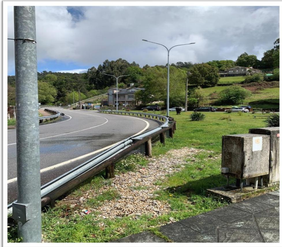
IMAXE Nº 6: Quitamedos a retirar, luminarias a retranquear, e creación de 10 prazas de aparcamento normais máis 2 prazas adaptadas, asía como creación de beirarrúa interior que conecte as prazas de aparcamento con beirarrúa existente.
